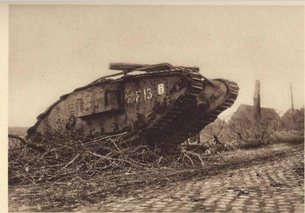
Englischer Tank auf dem Vormarsch (bei Cambrai). Die Ketten ermöglichten die Überwindung von größeren Hindernissen und Trümmern und gaben eine bessere Kletterfähigkeit. Auf deutscher Seite wurde die Wirkung des Tanks lange verkannt. Unsere Truppen hatten Anfang 1918 nur etwa 20, bei Kriegsende 45 Tanks an der Front, denen bei Waffenstillstand 5000 feindliche Tanks gegenüberstanden.
